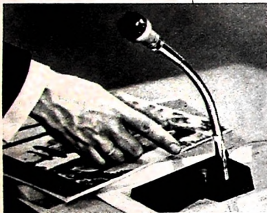
Bild 16. Sprachmikrofon „M 23“ mit Schwanenhals und Tischplatte (Beyer)
